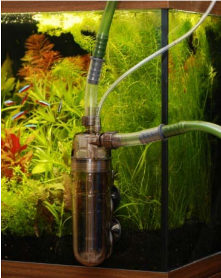
Reaktor 500 – provizorní umístění reaktoru pro focení na přední straně akvária s viditelnými redukcemi z 16/22 hadice na menší průměr filtru Eheim a to na velikost 12/16 mm.
